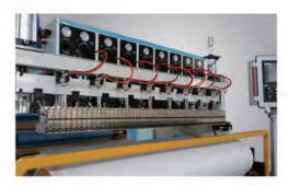
▲ NT1600热熔胶透气喷涂复合设备
