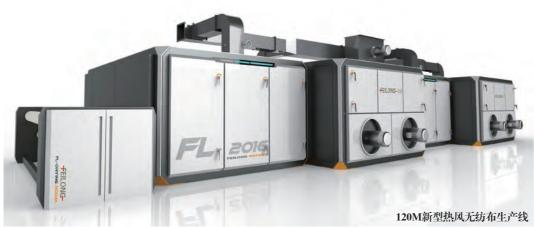
热风定型机 Hot air setting machine
