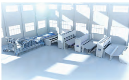
▲ 安德里茨用于生产无纺布产业用毡的高产能 neXline eXcelle 针刺生产线
