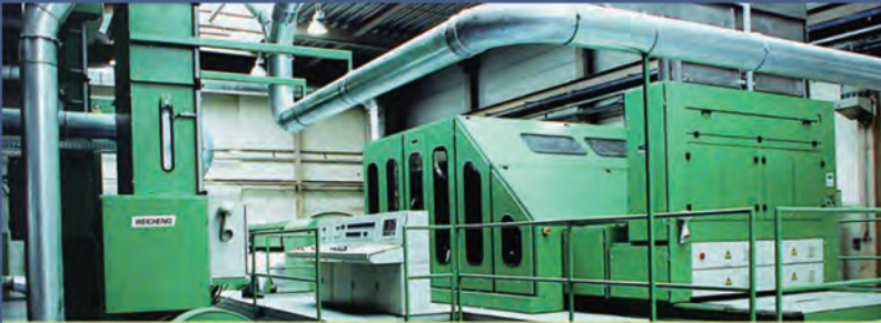
德国技术高速梳理机, 速度 \leq 150\text{m}/\text{min} HIGH SPEED CARDING
