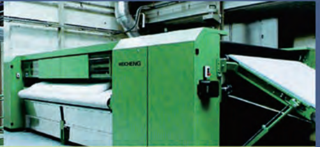
德国技术高速铺网机, 速度 \leq 150\text{m}/\text{min} HIGH SPEED CROSS LAPPER
