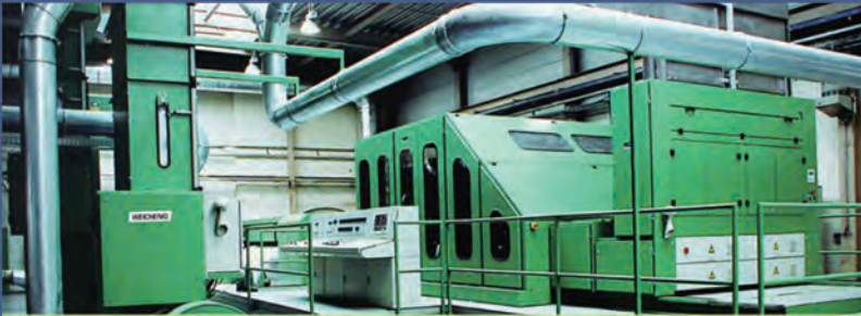
德国技术高速梳理机，速度 \leq 150\text{m/min} HIGH SPEED CARDING
