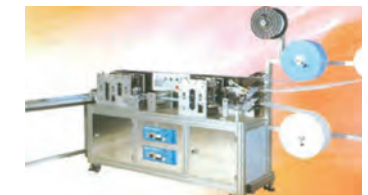
平面口罩制造机：120pcs/min
