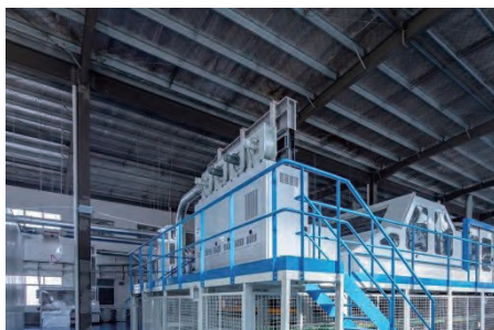
安德里茨neXline 水刺生产线采用中国生产的新型aXcess Varioweb 梳理机
